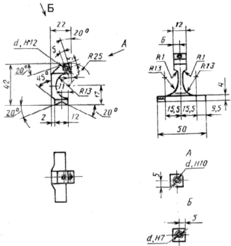
$d$  - диаметр резьбового отверстия для крепления вибропреобразователя
