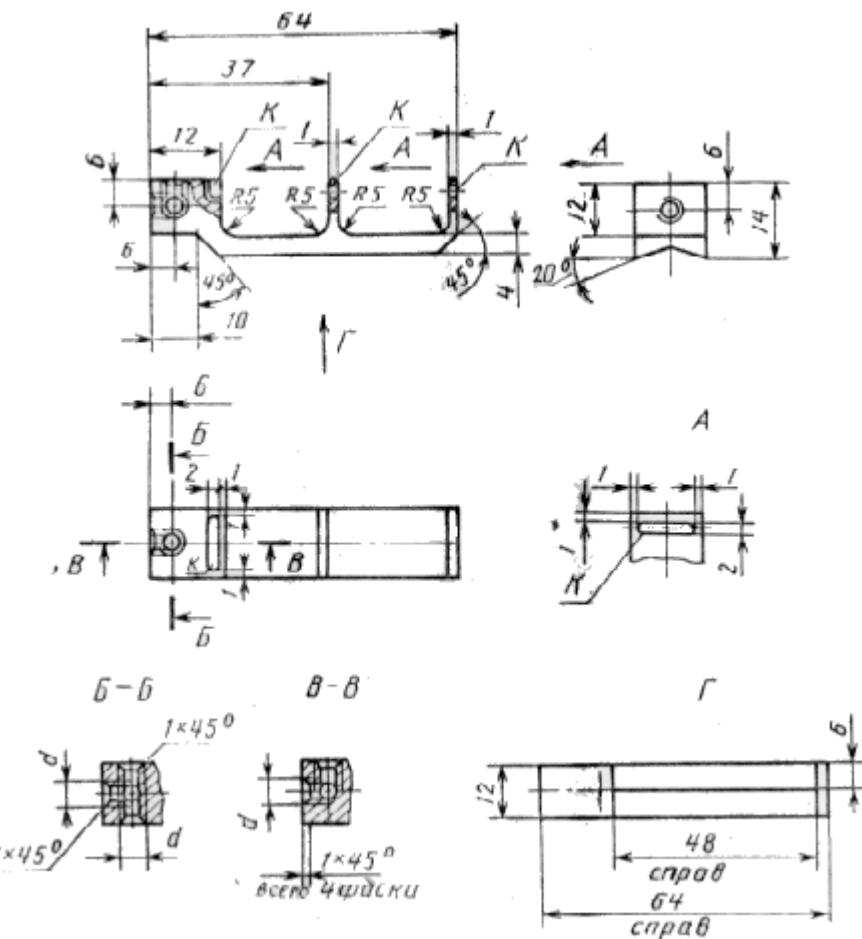
d - диаметр резьбового отверстия для крепления вибропреобразователя; K - отверстия, через которые могут быть пропущены резинки или ленты для охвата пальцев сверху
