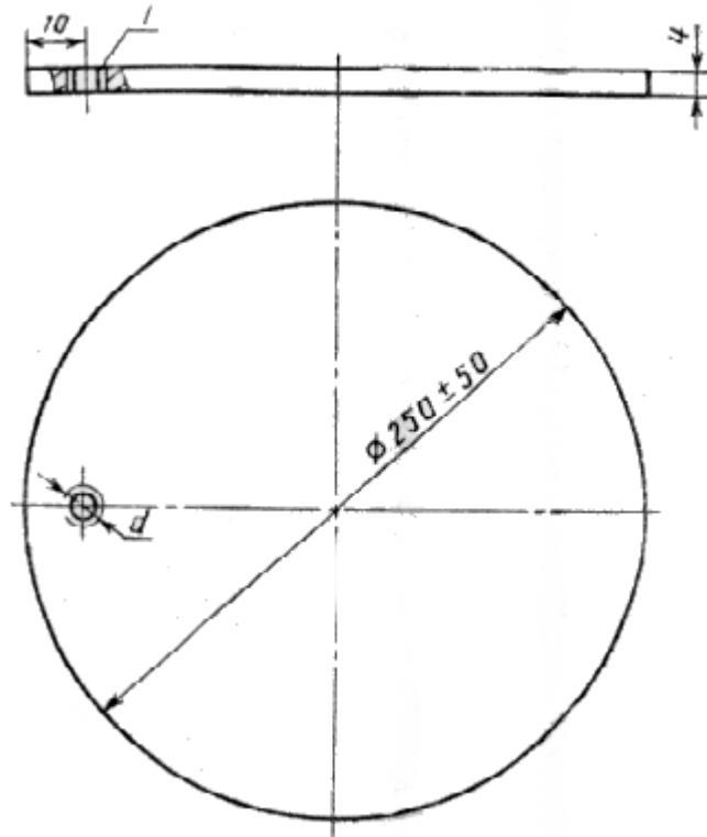
1 -резьбовое отверстие для крепления вибропреобразователя или кубика под вибропреобразователь
