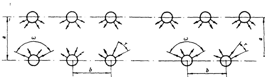
Омега - угол охвата, град.; тау - угол между оптическими осями, град.; а - ширина освещаемой площади, м; b - расстояние между мачтами, м.
