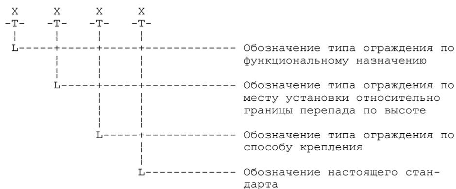
Пример условного обозначения ограждения защитного наружного опорного:
