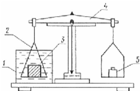
1 — сосуд с водой; 2 — подвес для образца; 3 — образец; 4 — весы;
