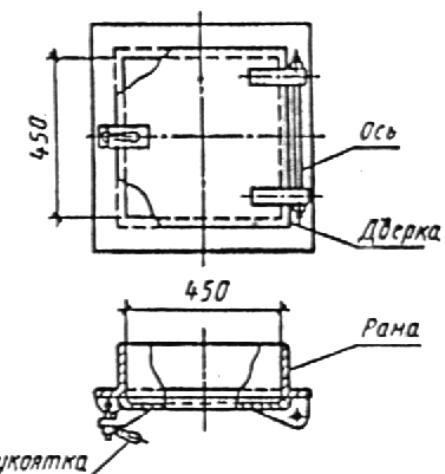
Люк сварной герметичный предназначен для чистки газохода. Толщина металла - не менее 3мм.
