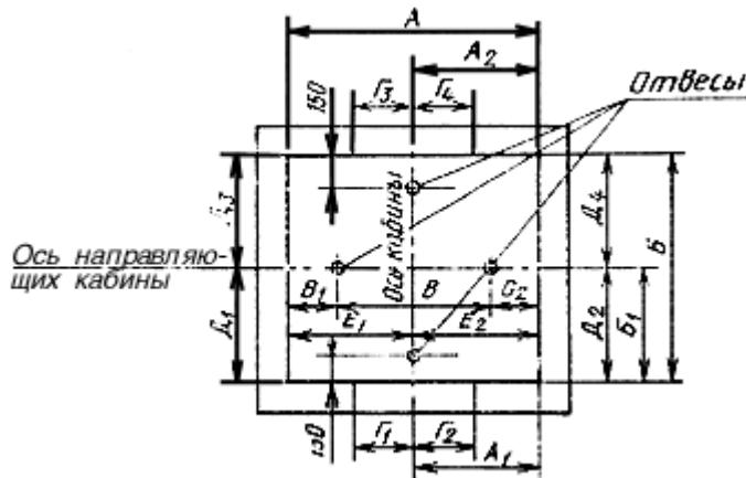
A, A<sub>1</sub>, B, B<sub>1</sub>, В - размеры, определяемые монтажным (установочным) чертежом. Размер В равен расстоянию между направляющими кабины минус 50 мм; A<sub>2</sub>, Г<sub>3</sub>, Г<sub>4</sub> - размеры для лифта с проходной кабиной; Е<sub>1</sub>, Е<sub>2</sub> - размеры для лифта с раздвижными дверями шахты
