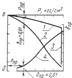
1, 2 - относительное сжатие  $\delta$  грунта с природной влажностью и в водонасыщенном состоянии в зависимости от давления; 3 - дополнительное относительное сжатие грунта в результате замачивания (относительная просадочность) при заданном давлении; 4 - зависимость относительной просадочности  $\delta_{np}$  от давления;  $P_{np}$  - начальное просадочное давление
