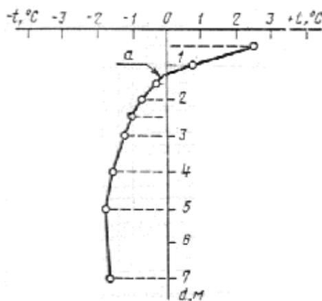
**График распределения температуры  $t$ ,  $^\circ\text{C}$ , грунта по длине  $d$ , м, для
