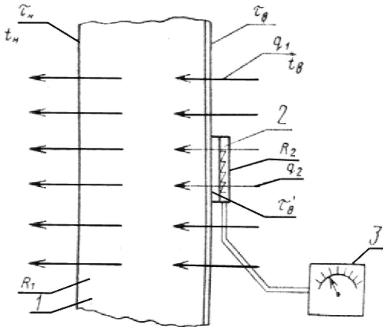
1 - ограждающая конструкция; 2 - преобразователь теплового потока; 3 - измеритель э.д.с.;
