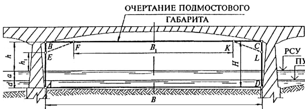
ABCDА и AEFKLDA - контуры подмостового габарита;
