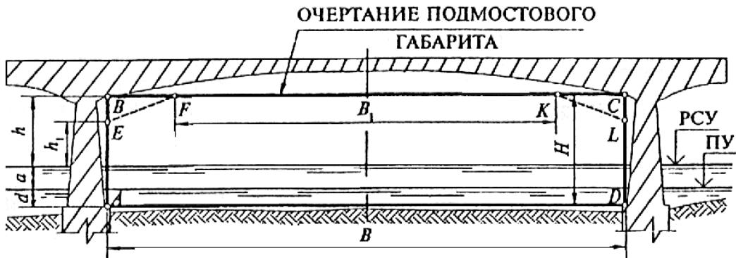
ABCDA и AEFKLD - контуры подмостового габарита;
