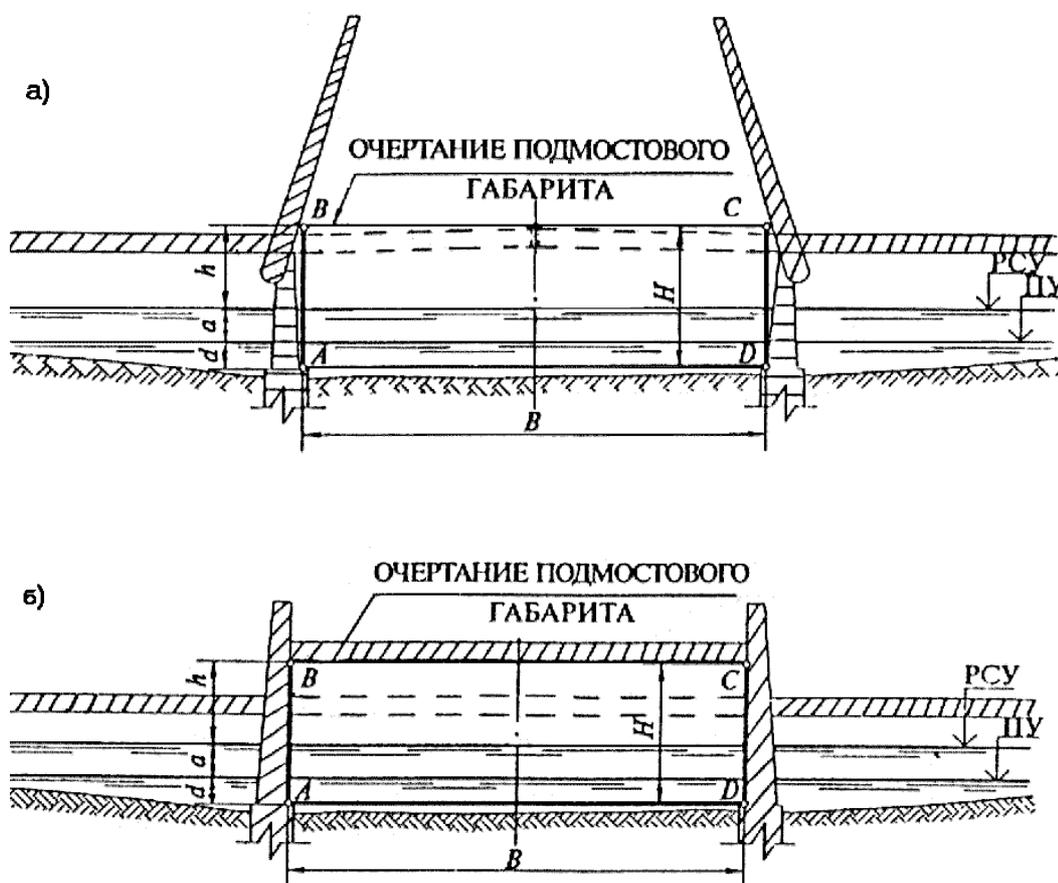
ABCDА - контур подмостового габарита;
