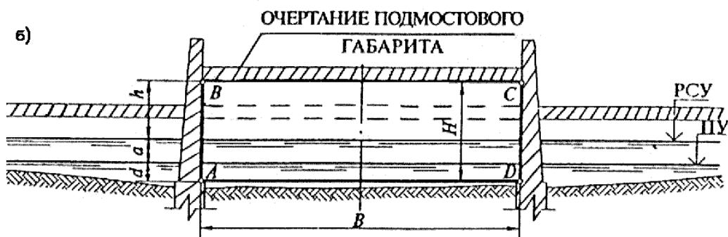
АБСДА - контур подмостового габарита;
