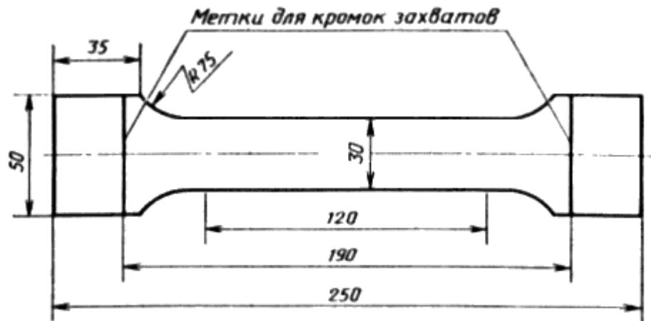
Перед испытанием на образец наносят метки, ограничивающие положение кромок захватов разрывной машины. Нанесение меток не должно приводить к изменению свойств образца и к его разрушению по меткам.
