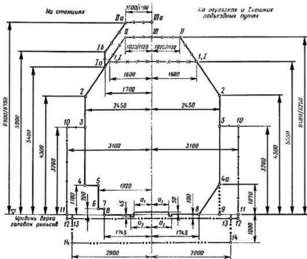
линия приближения пролетных строений мостов, конструктивных элементов тоннелей, галерей, платформ, настилов переездов, индукторов локомотивной сигнализации, механизмов стрелочных переводов и расположенных в их пределах устройств сигнализации, централизации и блокировки (СЦБ), а также сооружений и устройств, располагаемых на междупутьях станций в соответствии с п.2.10;
