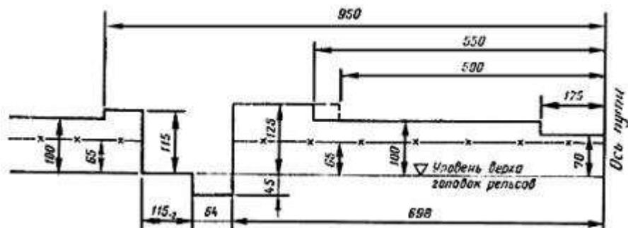
очертание, за пределы которого не должна выступать ни одна из частей подвагонного толкателя и других устройств для надвига вагонов в нерабочем положении при установке их на путях, по которым разрешается пропуск только грузовых вагонов;
