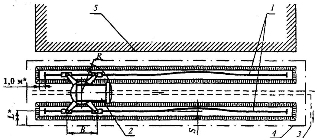
1 — рельсовый путь; 2 — башенный кран; 3 — водоотводное устройство; 4 — ограждение;
