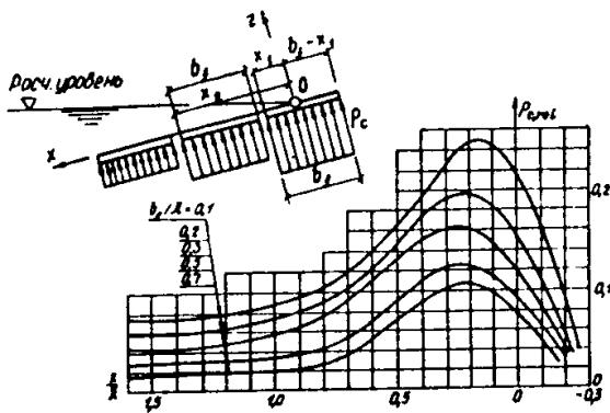
Рис.12. Графики для определения относительного волнового противодавления
