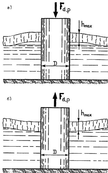
Рис.41. Схема приложения нагрузок от примерзшего к сооружению ледяного покрова при изменении уровня воды (УВ)
