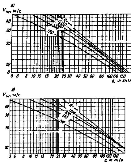
Графики для определения расчетной скорости ветра  $V_w$ , м/с, по данным синоптических карт при циклонических изобарах, проведенных через 0,5 кПа
