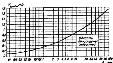
Рис.7. График допускаемых значений неразмывающих донных скоростей
