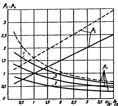
Рис.17. Графики значений инерционного  $\beta_i$  и скоростного коэффициентов формы (для эллиптических преград - сплошные линии, при призматических - штриховые линии) в зависимости от  $\alpha/b$  (для  $Q$ ,  $q$  и  $P_x$ ) или  $b/\alpha$  (для  $P_z$ )
