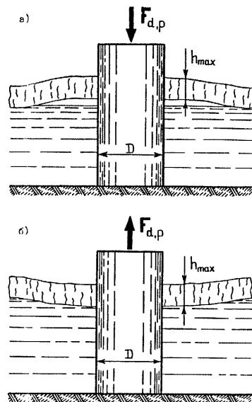
Рис.42. Схемы приложения нагрузки от примерзшего к отдельно стоящей опоре ледяного покрова при изменении уровня воды (УВ)
