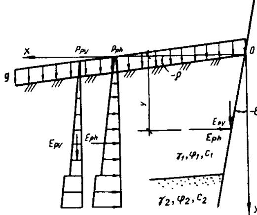
Черт. 3. Схема к расчету пассивного давления грунта
