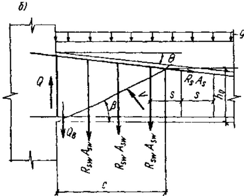
Черт. 6. Схема усилий в сечении, наклонном к продольной оси железобетонного элемента, наклонной гранью при расчете его по прочности на действие поперечной силы
