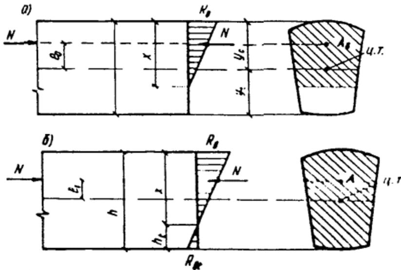
Черт. 1. Схема усилий и эпюра напряжений в сечении, нормальном к продольной оси внецентренно сжатого бетонного элемента
