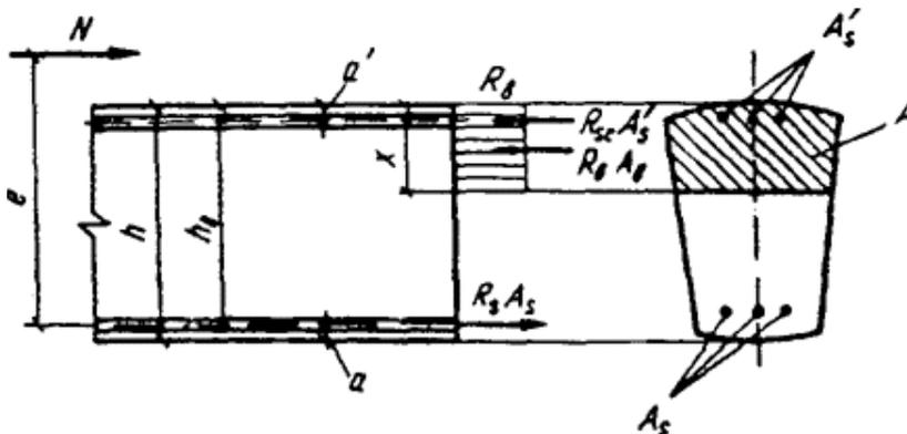
Черт. 3. Схема усилий и эпюра напряжений в сечении, нормальном к продольной оси внецентренно сжатого железобетонного элемента, при расчете его по прочности
