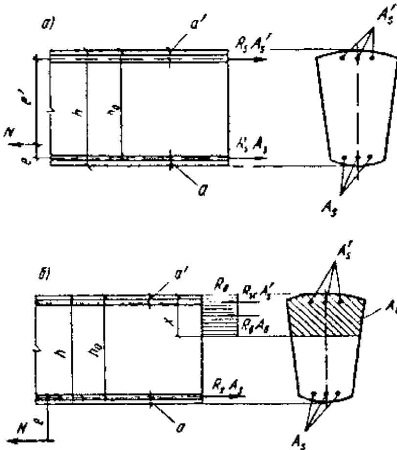
Черт. 4. Схема усилий и эпюра напряжений в сечении, нормальном к продольной оси внецентренно растянутого железобетонного элемента, при расчете его по прочности
