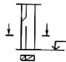
5. Отверстия присоединения в шахтах и каналах обозначают тонкими линиями. Горизонтальный разрез во всех случаях выполняют по шахте.
